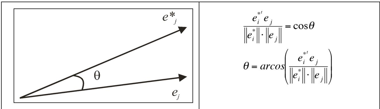
Ad ogni prodotto scalare del sistema di trasformazione può essere applicata la relazione con il coseno (tenuto conto del giusto angolo)
