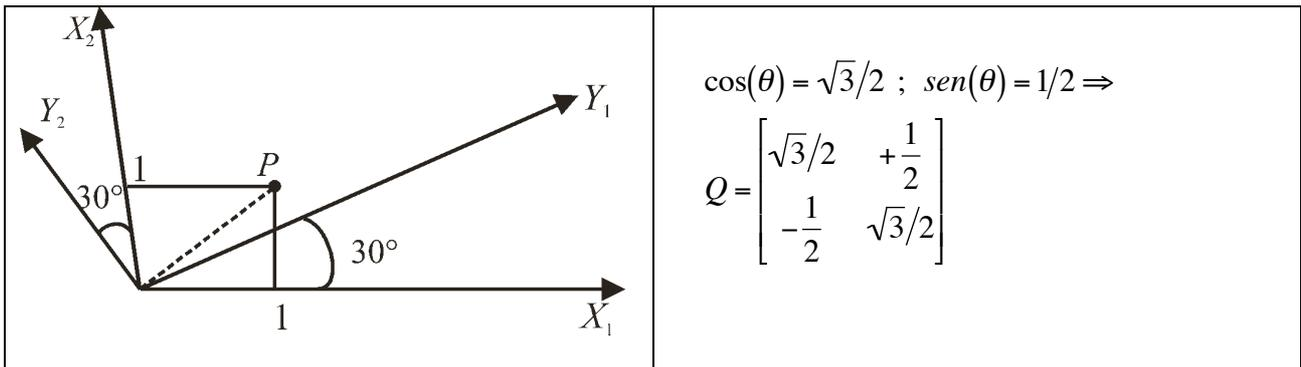
Il punto P rimane fermo. È il sistema degli assi che ruota. Se  $P=(1,1)$  nel sistema  $(x_1, x_2)$  nel nuovo sistema  $(y_1, y_2)$  diventerà
